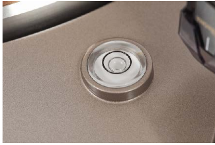
W tym celu zainstalowano na niej poziomnicę.
